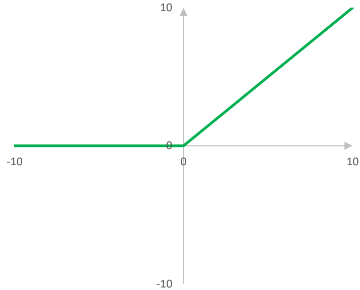
Rys. 4.8. Funkcja aktywacji ReLU (ang. Rectified Linear Unit).
