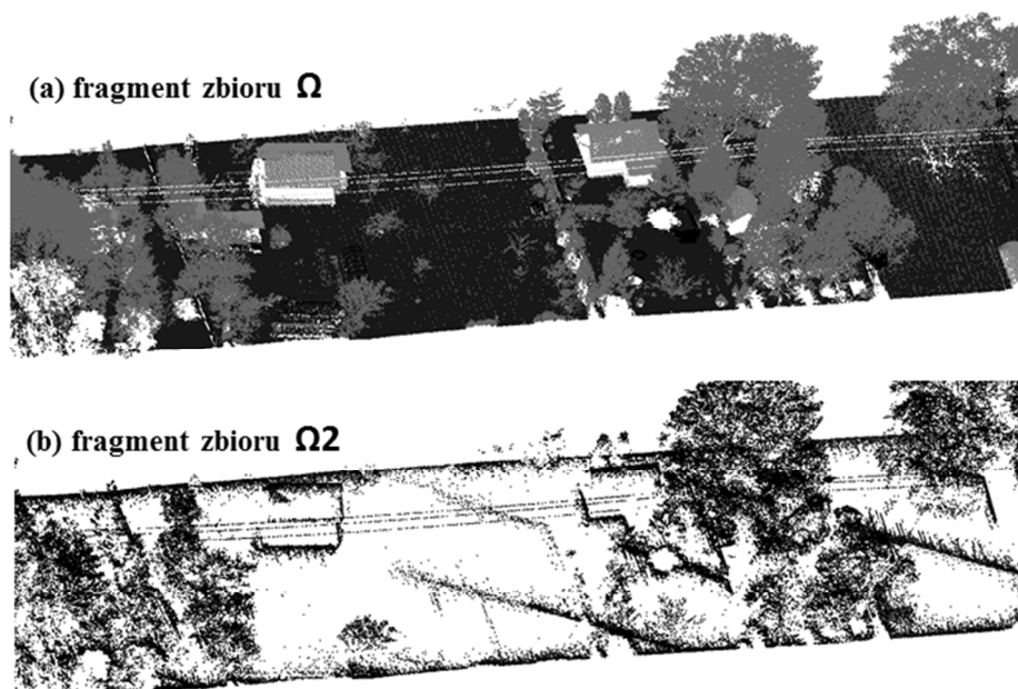
Rys. 6. Powiększony fragment chmury punktów ALS (a) zbiór \Omega , (b) zbiór \Omega_2 (źródło: opracowanie własne w CloudCompare v.2.6.0)
