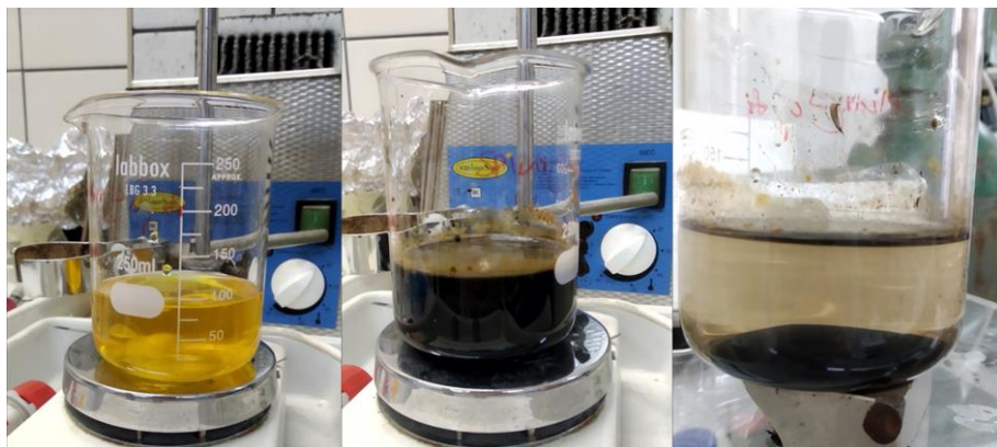
Rysunek 2. Od lewej: wodny roztwór mieszaniny \text{FeCl}_2 i \text{FeCl}_3 ; zawiesina powstałych nanocząstek; zdekantowane nanocząstki na magnesie neodymowym [opracowanie własne]
