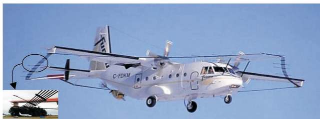
Rys. 10. System elektromagnetyczny GEOTEM z cewką zainstalowaną na skrzydłach samolotu Casa 212 firmy Fugro [9]
