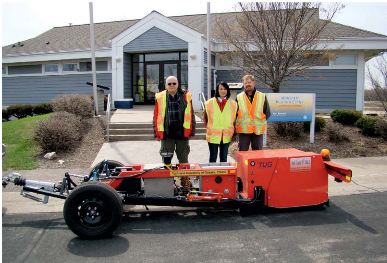
Rys. 7. Przyczepa do badania oporu toczenia R 2 Mk. 2 wraz z ekipą pomiarową podczas badań w MnRoad Facility w 2014 roku
