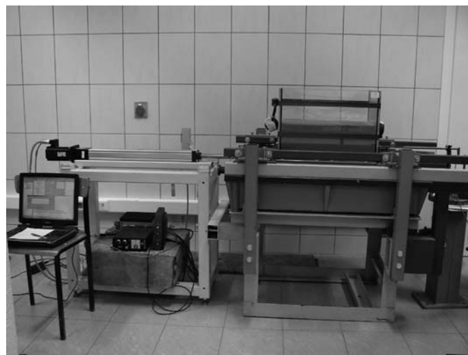
Rys. 1. Stół sejsmiczny, do którego przymocowano akwarium Wewnątrz akwarium usypano warstwę piasku
