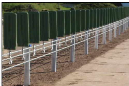
Rys. 2.11 Bariera z prowadnicą linową
