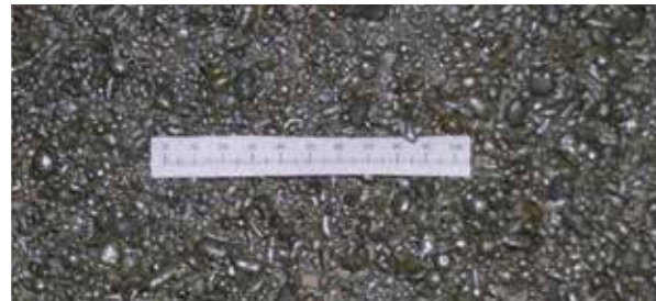
Rys. 6. Uzyskany granulaty o kształcie zbliżonym do globularnego
