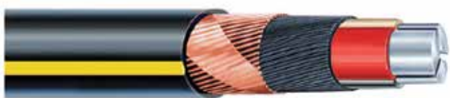
Rys. 7. Widok kabla o trzech żyłach aluminiowych o izolacji z kauczuku etylenowo-propylenowego (EPR), oplecionych drutami miedzianymi, jako żyły ochronno-neutralnej. Źródło: [10]
