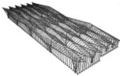
Rys. 2. Globalny model MES Terminalu (SOFiSTiK)
