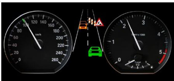
Rys. 3.5. Usytuowanie wyświetlacza systemu ADAS w pojeździe [4]
