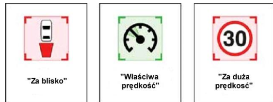
Rys. 3.7. Przekazywanie wskazówek kierowcy przez system Foot-LITE [12]
