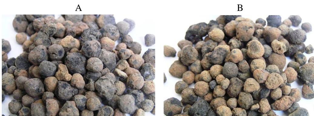
Rysunek 77. Ziarna kruszywa A – niemodyfikowanego PCM, B – wysyconego PCM
