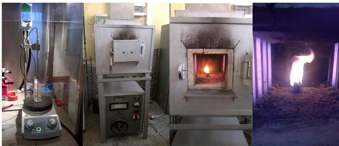
Rysunek 26. Od lewej mieszadło magnetyczne z termoparą, z funkcją grzania oraz piec użyty do badań, umożliwiający kontrolę temperatury
