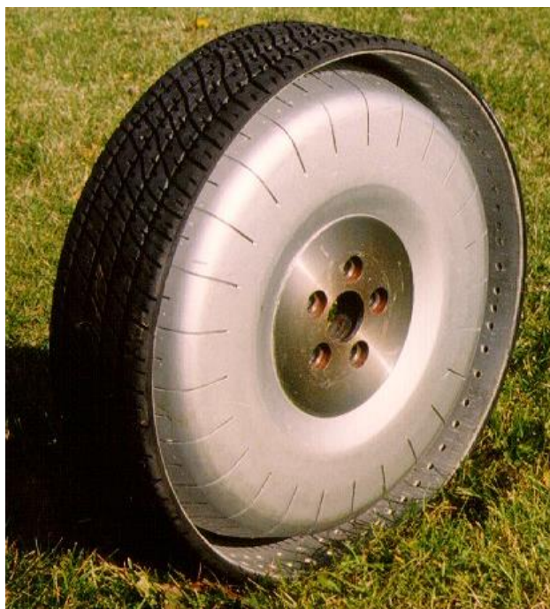
Rys. 5. Prototyp koła kompozytowego wersja I [4].
