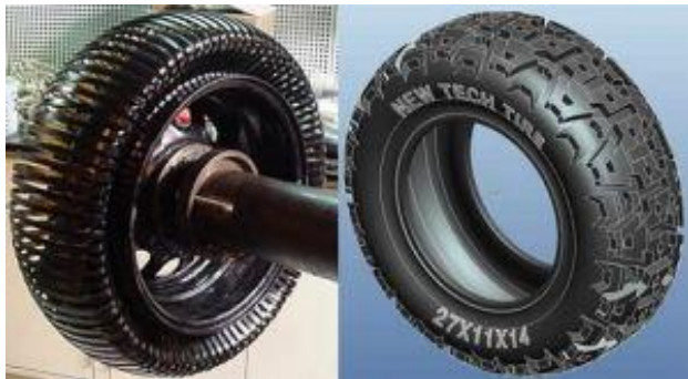
Rys. 18. Koło niepneumatyczne firm SciTech Industries i Rapid Composites [14].
