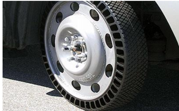
Rys. 16. Koło niepneumatyczne Amerityre firmy Amerityre [12].
