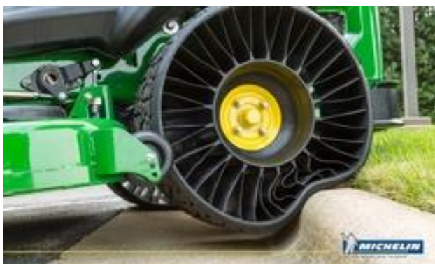
Rys. 10. Koła Tweel firmy Michelin zastosowane w kosiarce [6].
