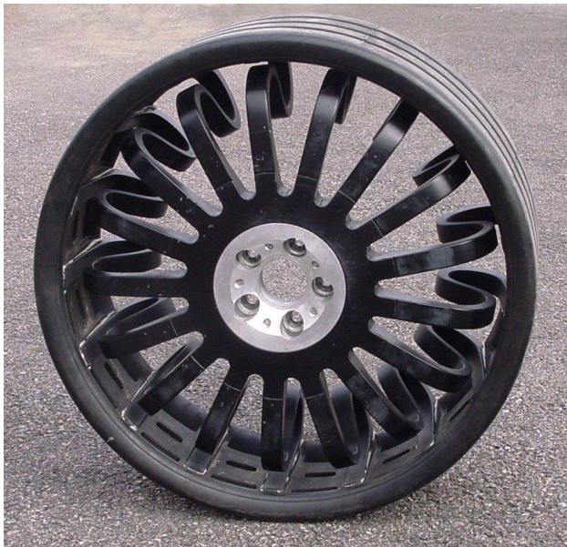
Rys. 6. Prototyp koła kompozytowego wersja III [4].
