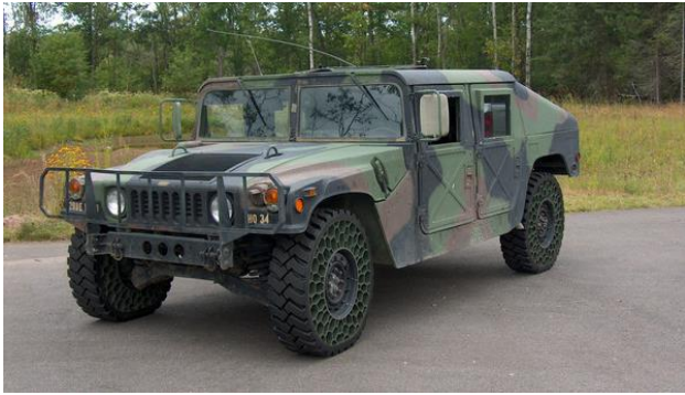
Rys. 14. Samochód wojskowy HMMWV na kołach niepneumatycznych firmy Resilient Technologies (obecnie Polaris) [10].
