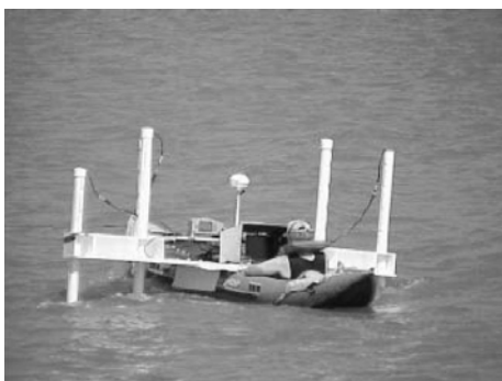
Rys. 12. System magnetometryczny: Geonix 852 [12] Fig. 12. Geonix 852 magnetic system [12]
