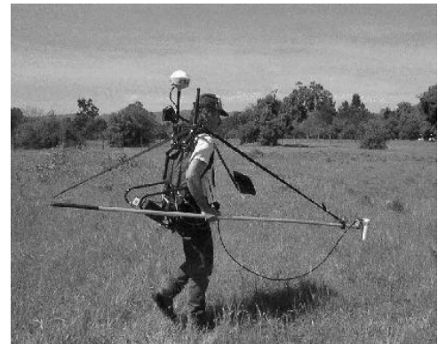
Rys. 9. System magnetometryczny z magnetometrem pompowanym optycznie (www.geometrics.com)
