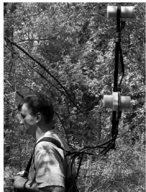
Rys. 10. System magnetometryczny z magnetometrami protonowymi (www.gemsys.ca)
