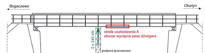
Rys. 12. Schemat wyparcia przęśla podczas naprawy
