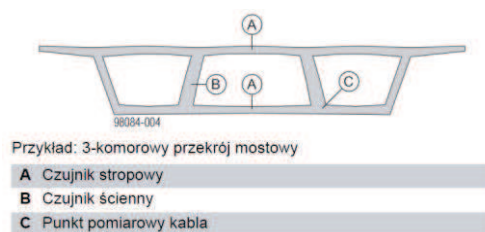
Rys. 3.18. Przykładowy układ czujników pomiarowych [164]
