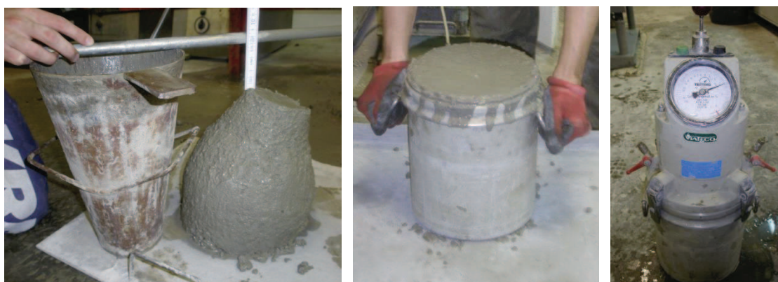
Rys. 4.1. Badania mieszanki betonowej
