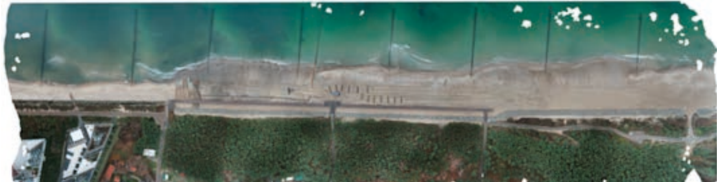
Rys. 12. Refulacja plaży w Mielnie (11.2022) [2]
