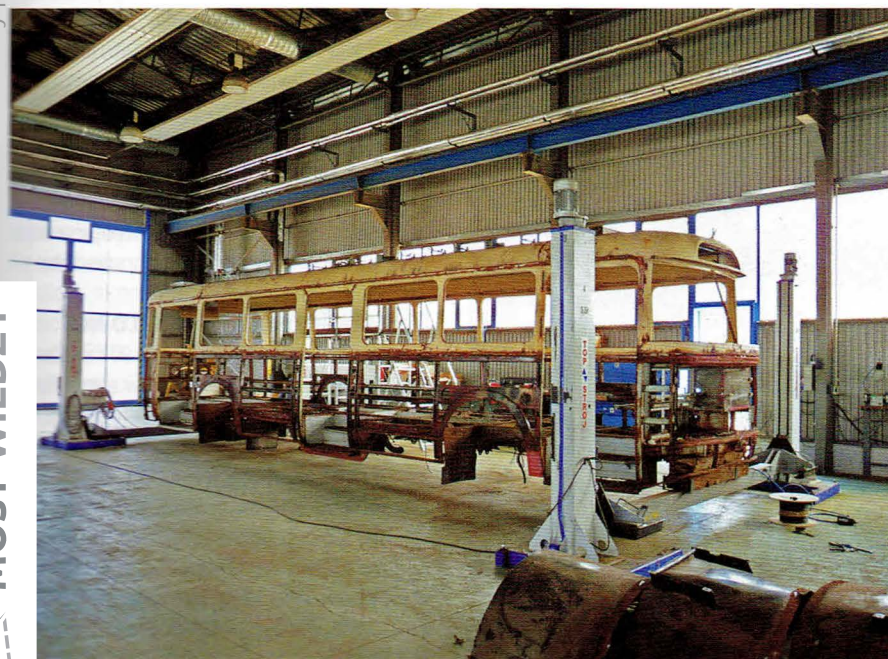
Prace nad konstrukcją po zakończeniu demontażu Škody
