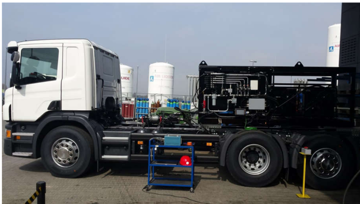
Rys. 9.1. Scania P320 podczas testów weryfikacyjnych. Na ramie podwozia zamontowane zostało stanowisko testowe (patrz Załącznik A).
