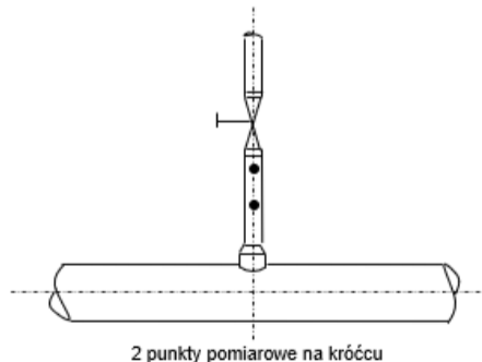
Rys 11. Króćiec bez korka (z wolnym wylotem), DN ≤ 2"
