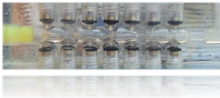
Zdjęcie 26. Przetłaczanie powietrza przez tunel celki pomiarowej.
