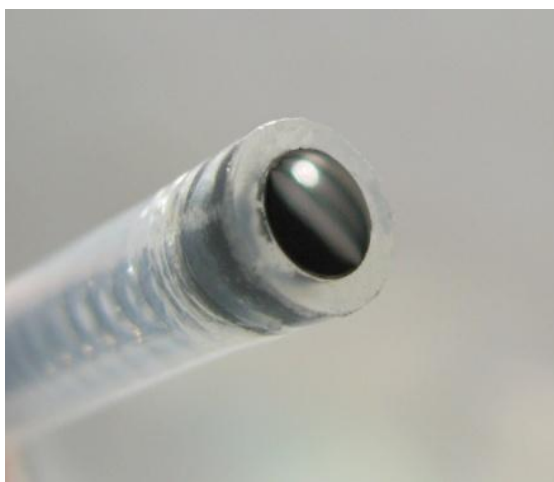
Zdjęcie 10. Powierzchnia elektrody pomiarowej według procedury III.2.1.
