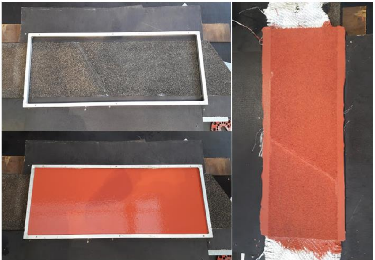
Rysunek 43. Proces tworzenia warstwy elastycznej stanowiącej negatywowe odwzorowanie nawierzchni drogowej
