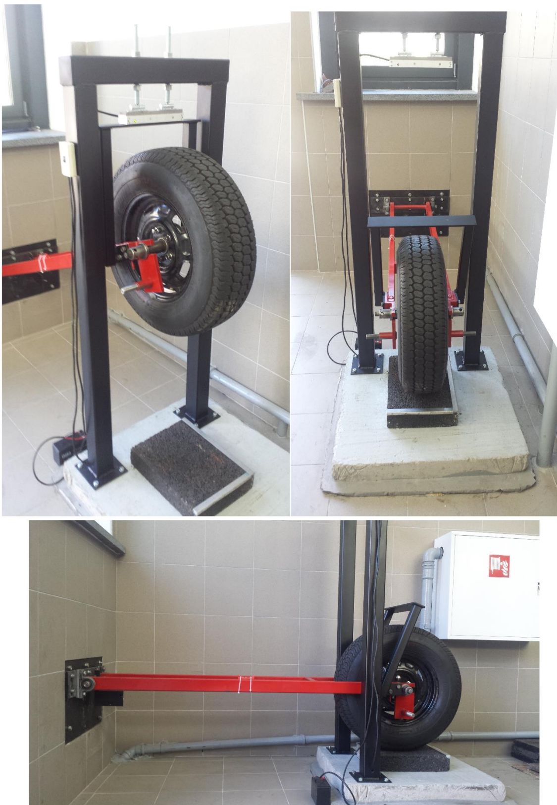
Rysunek 48. Widok urządzenia do wykonywania pomiarów metodą oscylacyjną
