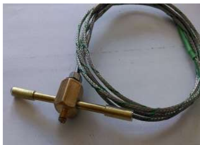
Rys. 3. Widok ogólny termopary płaszczonej umieszczonej w osłonie z płaszczem wodnym
