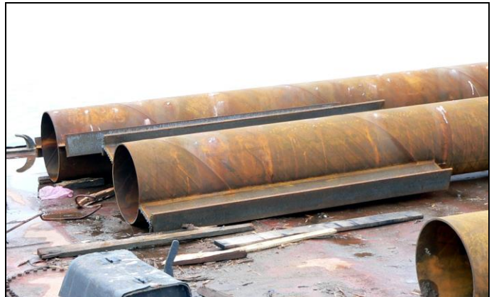
Rys. 5. Pali rurowe z dospawanymi „skrzydełkami”
