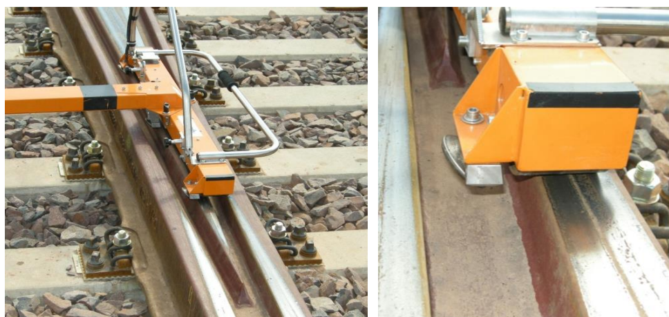
Fot. 6. Przejazd przez krzyżownicę kierunek na wprost
