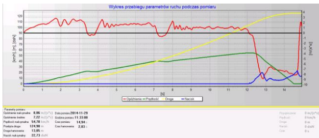
Rys. 9. Sprawny układ hamulcowy. Maksymalne opóźnienie hamowania 8,86 m/s 2 , wartość średniego rozwiniętego opóźnienia hamowania 7,22 m/s 2 , czas hamowania 2,83 s
