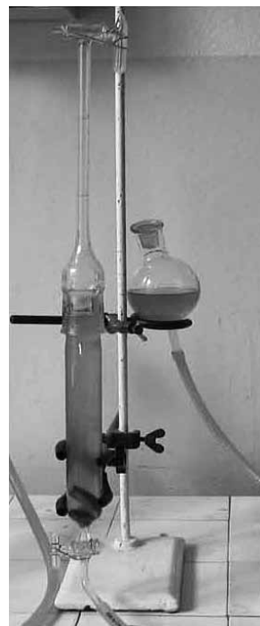
Rys. 1. Stanowisko do oznaczania ilości wodoru dyfundującego metodą glicerynową
