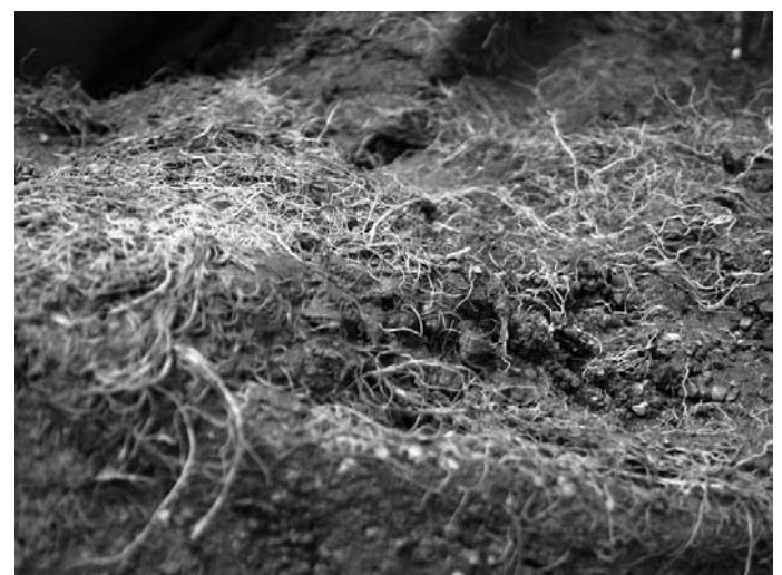
Rys. 11. Kolmatacja geowłókniny pyłem i korzeniami roślin
