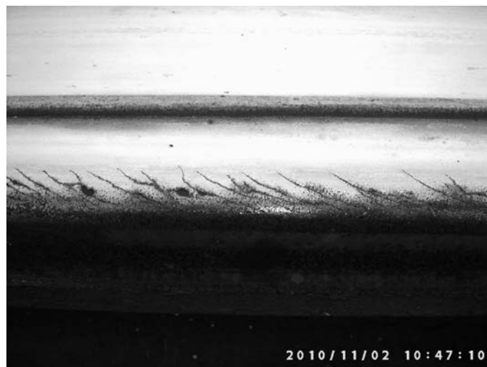
Rys. 15. Uszkodzenia head check na powierzchni toczonej iglicy prostej
