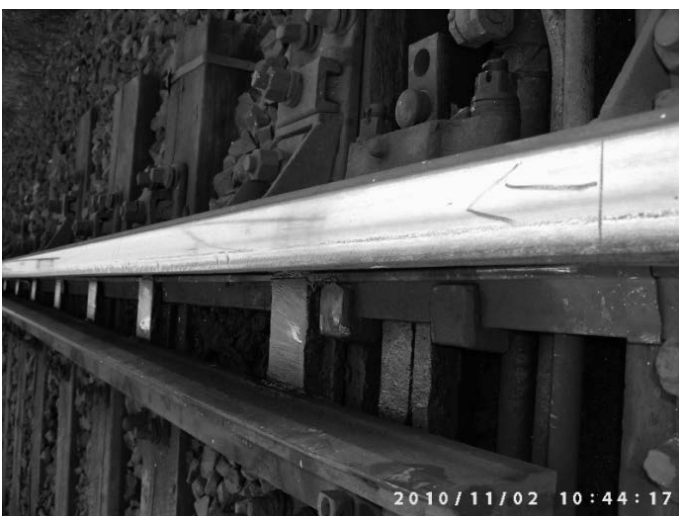
Rys. 14. Wady head check na powierzchni toczonej opornicy
