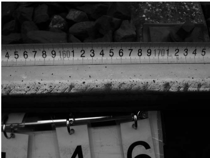
Rys. 4. Wada head check – rysy z zaciemnionymi zagłębieniami
