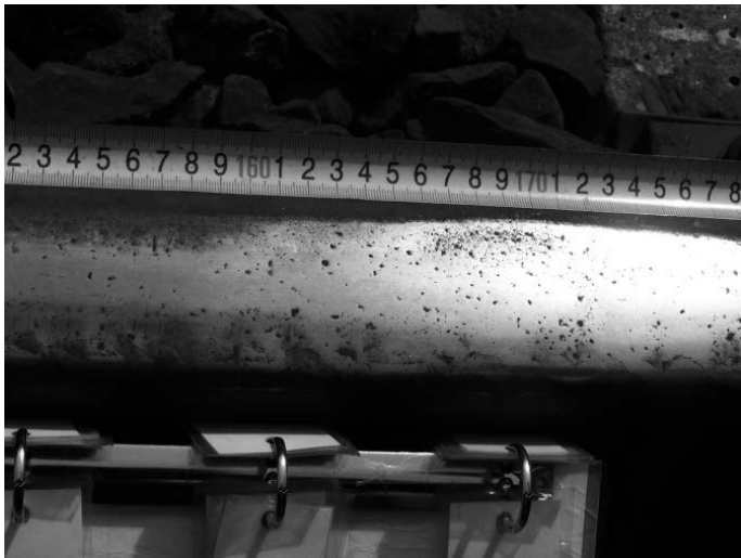
Rys .3. Wada head check – rysy z powstającymi łuskami
