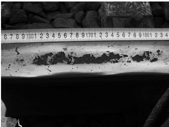
Rys. 1. Wada shelling powierzchni tocznej
