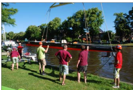
Rys. 6. Wodowanie łodzi solarnej ENERGASOLAR, po prawej stronie widać pędnik azymutalny
