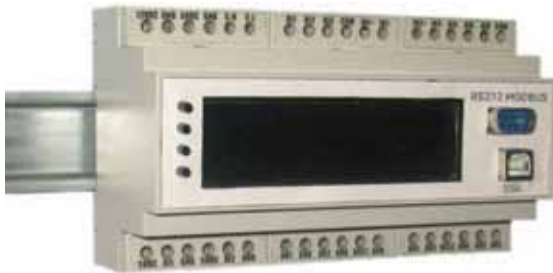
Rys. 8. Rzeczywiste zdjęcie zbudowanego sterownika programowalnego Fig. 8. Real photo of built programmable logic controller
