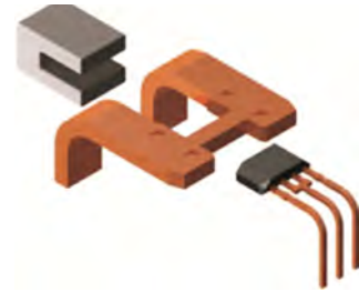
Rys. 9. Struktura wewnętrzna czujnika [2]
