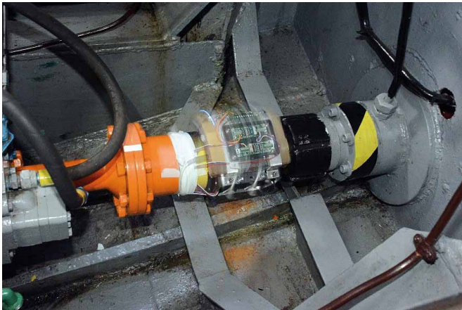
Rys. 3. Układ do pomiaru momentu obrotowego oraz siły naporu wirującej wraz z wałem napędowym podczas badań na statku
