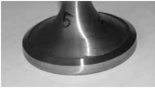
Rys. 3. Zawór po obróbce mechanicznej Fig. 3. Valve after machining
