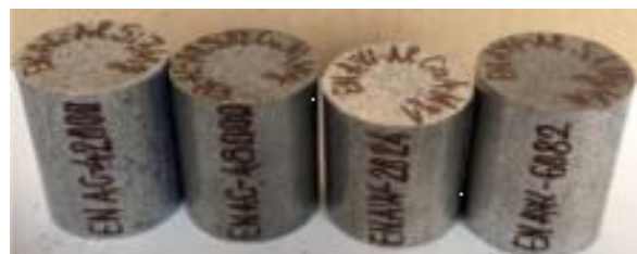
Фиг. 2. Получени образци от използваните четири вида алуминиеви сплави.
