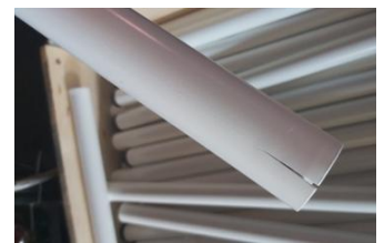
Фиг.11. Спукан заваръчен шев
