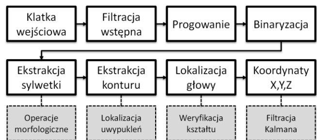
Rys. 2. Schemat funkcjonalny zaproponowanego systemu śledzenia głowy
