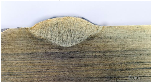
Rys. 65. Przekrój poprzeczny napoiny BWN4-2, q_l=0,97 kJ/mm, DC (-)
