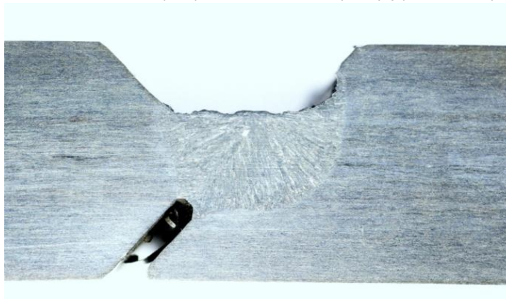
Rys. 108. Próбка Tekken 2TBM - przekrój spoiny próbnej wykonanej w wodzie morskiej elektrodami BÖHLER. Brak pęknięć
