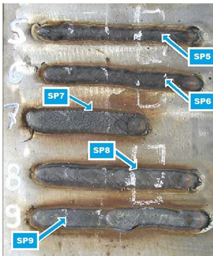
Rys. 60. Widok napoin wykonywanych na powietrzu metodą MIG. Strzałkami zaznaczono przekroje (próbki) pobrane do dalszych badań
