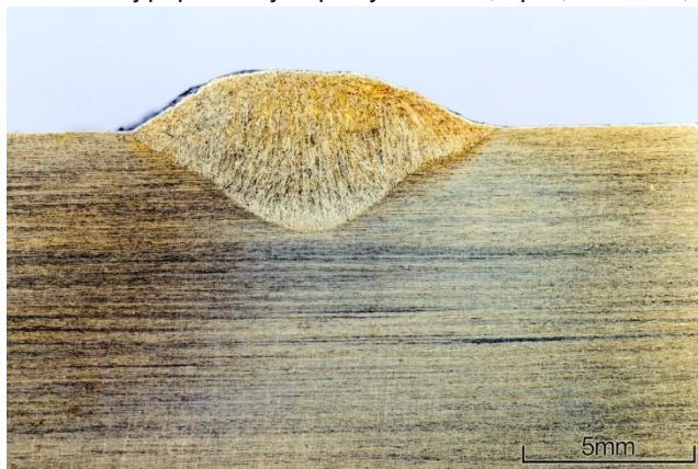
Rys. 67. Przekrój poprzeczny napoiny BWN6-1, q_l=1,06 kJ/mm, DC (-)
