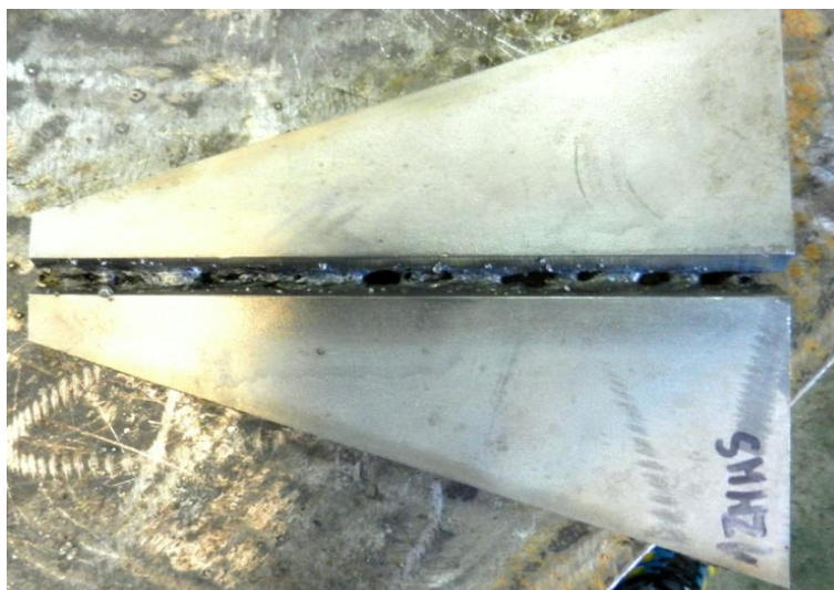
Rys. 118. Widok spoiny próbnej w próbce o zmieniającej się sztywności 1 ZBS wykonanej w wodzie wodociągowej
