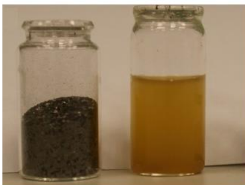
Płatki grafitowe (po lewej) oraz zawiesina tlenku grafenu (po prawej).
