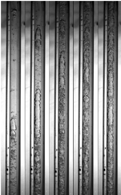
Rysunek 6: Struktury przepływu Pzr=0,6 G=180 kg/(m 2 *s) stopnie suchości kolejno: 37,2%, 48,6%, 64,6%, 72,8%, 93%
