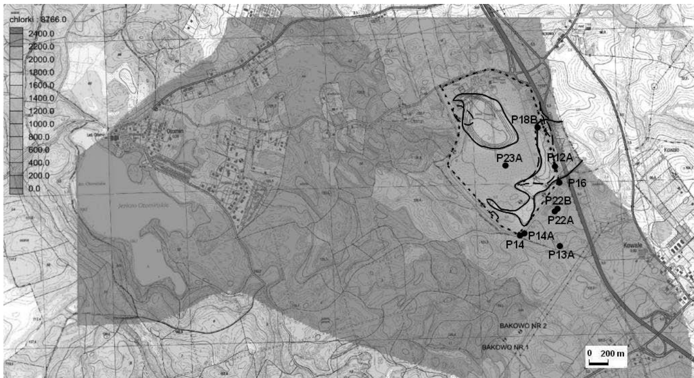
Rys. 6. Zasięg chmury jonów chlorkowych o stężeniu 200 mg/l dla warstwy nr 3 (Q12) po jednym miesiącu (linia kreskowana) i po 12 miesiącach (linia ciągła), zasięg składowiska – linia kropkowana
