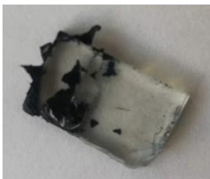
Rysunek 6.11 Zdjęcie warstwy PEDOT/GOx/(1.0)oxMWCNTs osadzonej ładunkiem 800 mC cm -2 na podłożu FTO, po wysuszeniu.
