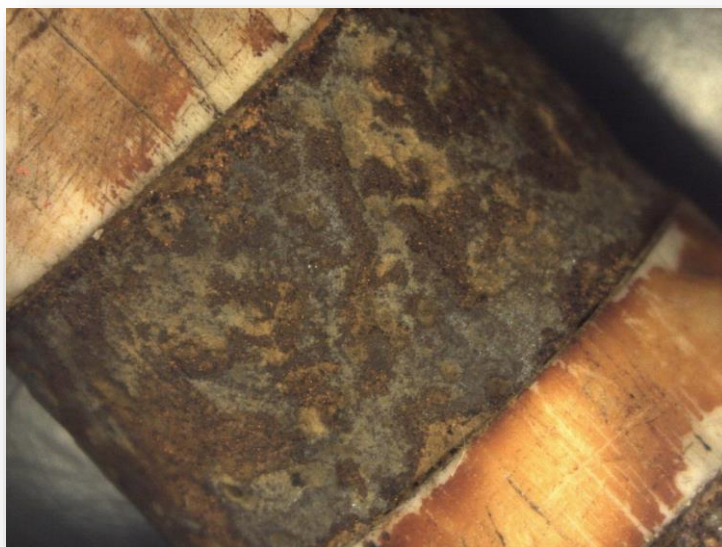
Rysunek 51. Stan czujnika przed wieżą odtleniającą.
