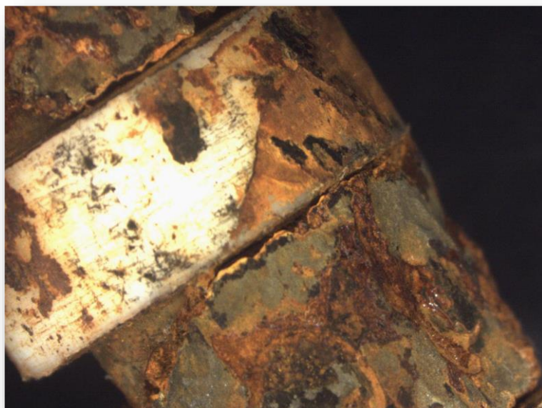
Rysunek 51. Stan czujnika przed wieżą odtleniającą.
