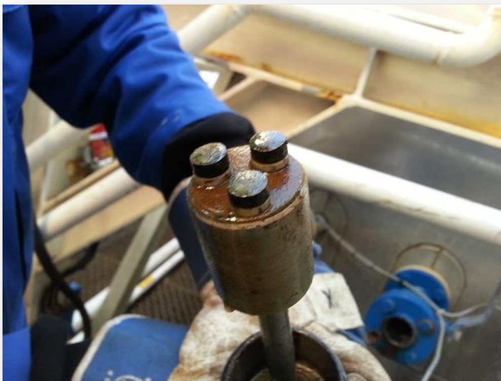
Rysunek 22. Czujnik monitorowania korozji.
