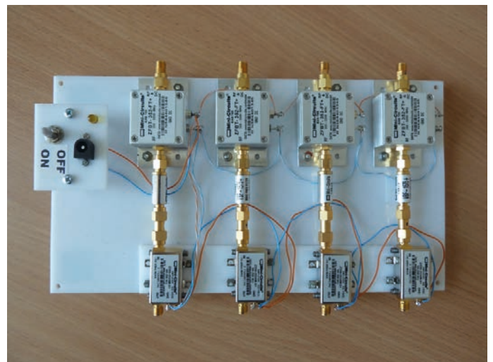
Rys. 3. Analogowe tory sygnałowe w.cz.
