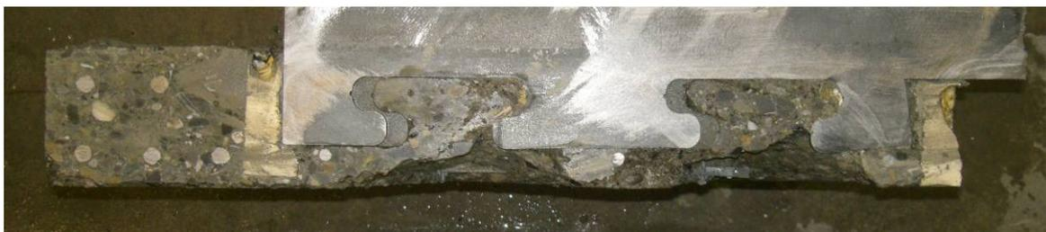
Bild 13: Prüfkörper Nr. 2 nach dem Zerlegen: unverformter Stahlsteg
