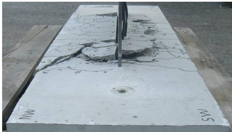
Bild 18: Ausbruchkegel beim Ausziehversuch
