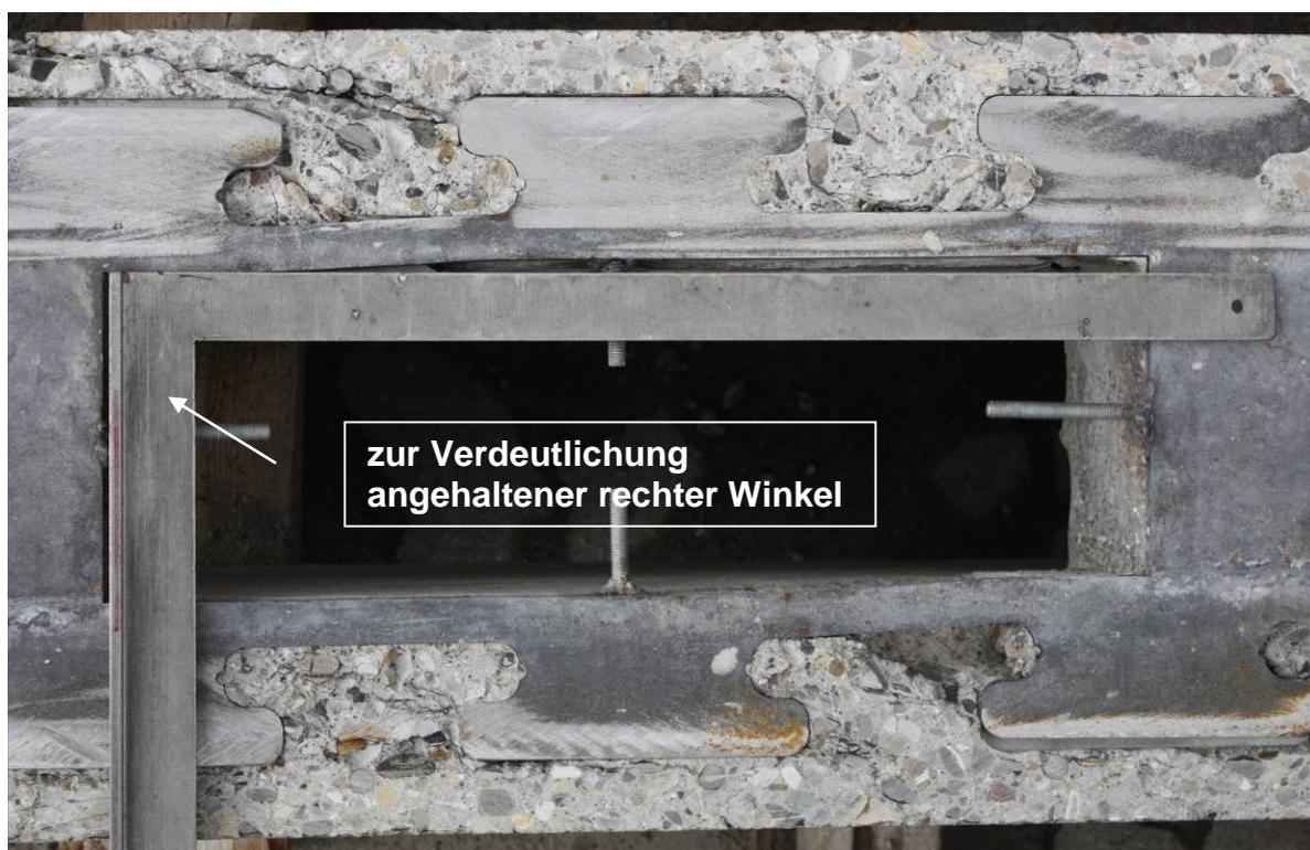
Bild 21: Eckige Stegöffnung nach Zersägen des Versuchsträgers
