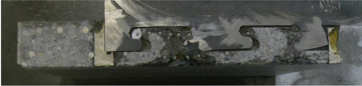
Bild 14: Prüfkörper Nr. 6 nach dem Zerlegen: verformter Stahlsteg
