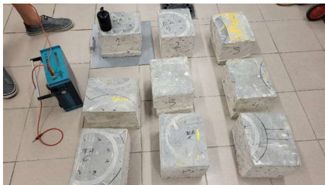
Rys. 12.2. Próbkę pobrane z posadzki w ramach badań polowych (fot. S. Świątek-Żołyńska)
