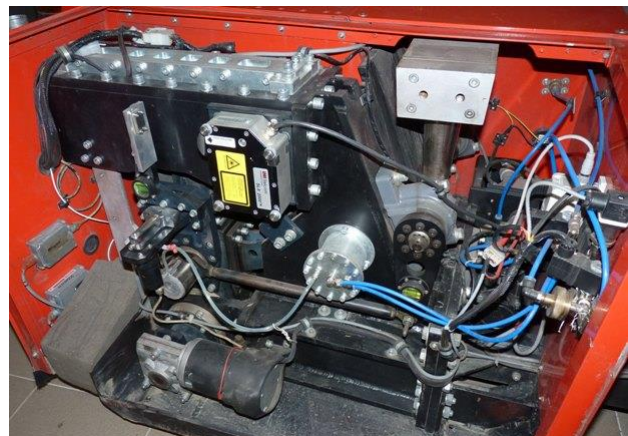
Rys. 3. Ustrój pomiarowy przyczepy R 2 Mk.2
