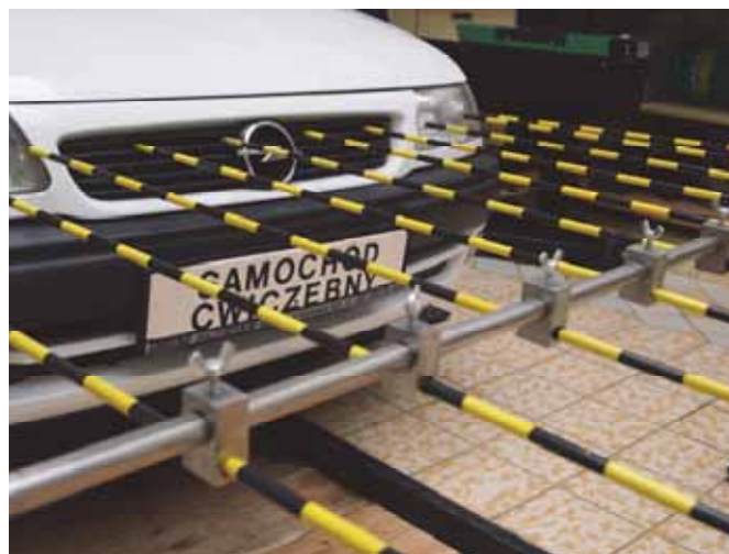
Rys. 4. Widok mocowania prętów pomiarowych do listwy poziomej
