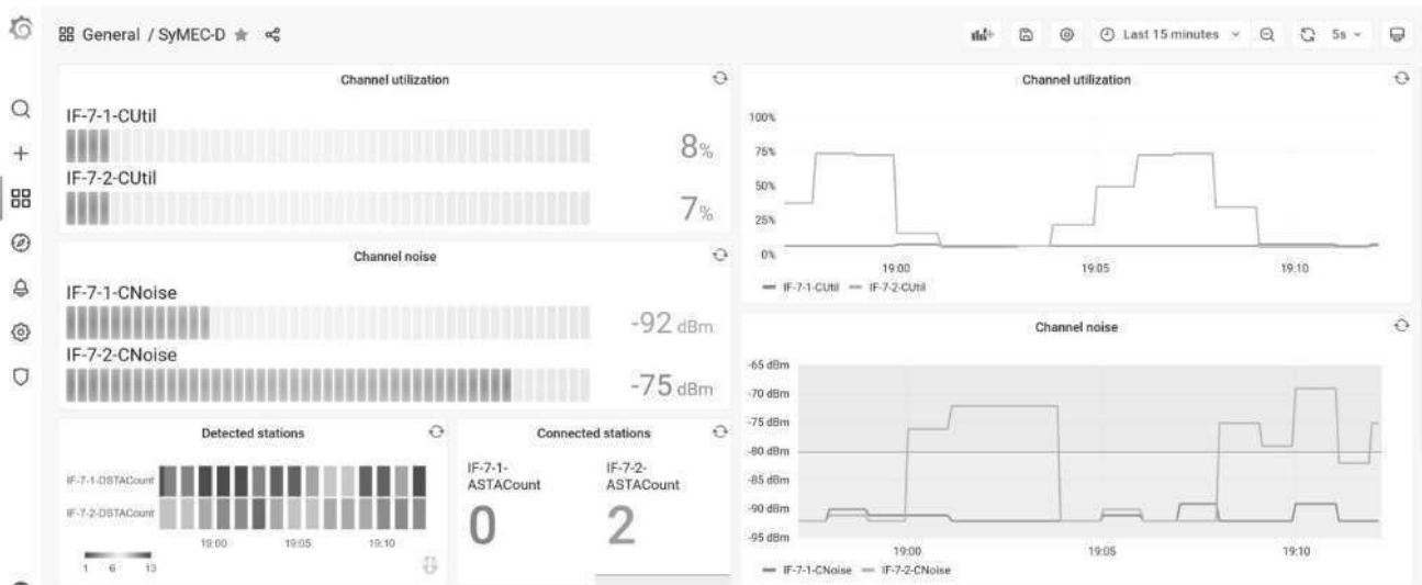
Rys. 3. Przykładowy wizualizacja danych z modułu współpracy z sieciami WLAN
