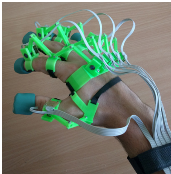
Rys. 7. Konstrukcja fantomu nakładanego na dłoń operatora
