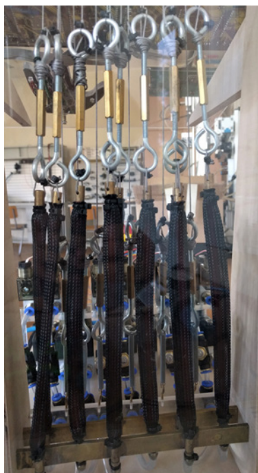
Rys. 5. Konstrukcja mechaniczna: a) układ napędowy chwytaka, b) układ pneumatyczny mięśnia
