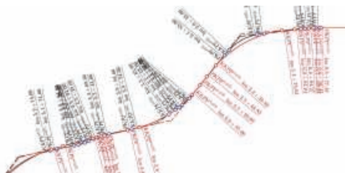
7. Wynikowy układ geometryczny powstały na drodze optymalizacji układu wyjściowego z założeniem kryterium minimalizacji przesunięcia toru [12]
