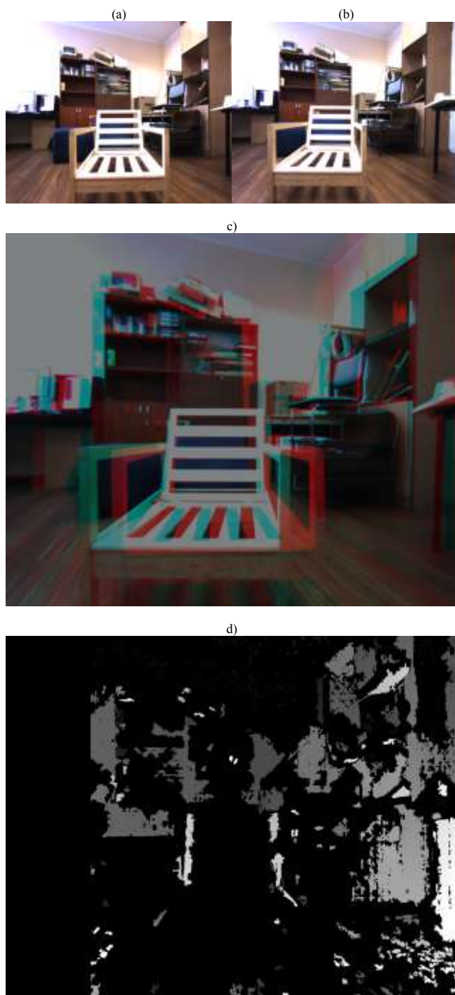
Rys. 8. Zobrazowanie obiektu dla bazy stereo B=20 cm: a) obraz lewy, b) prawy obraz, c) dysparycja – obraz anaglifowy, d) ‘daleka’ mapa głębi Fig. 8. Visualization of an object with baseline B=20 cm: a) left image, b) right image, c) disparity – anaglyph image d) ‘distant’ depth map
